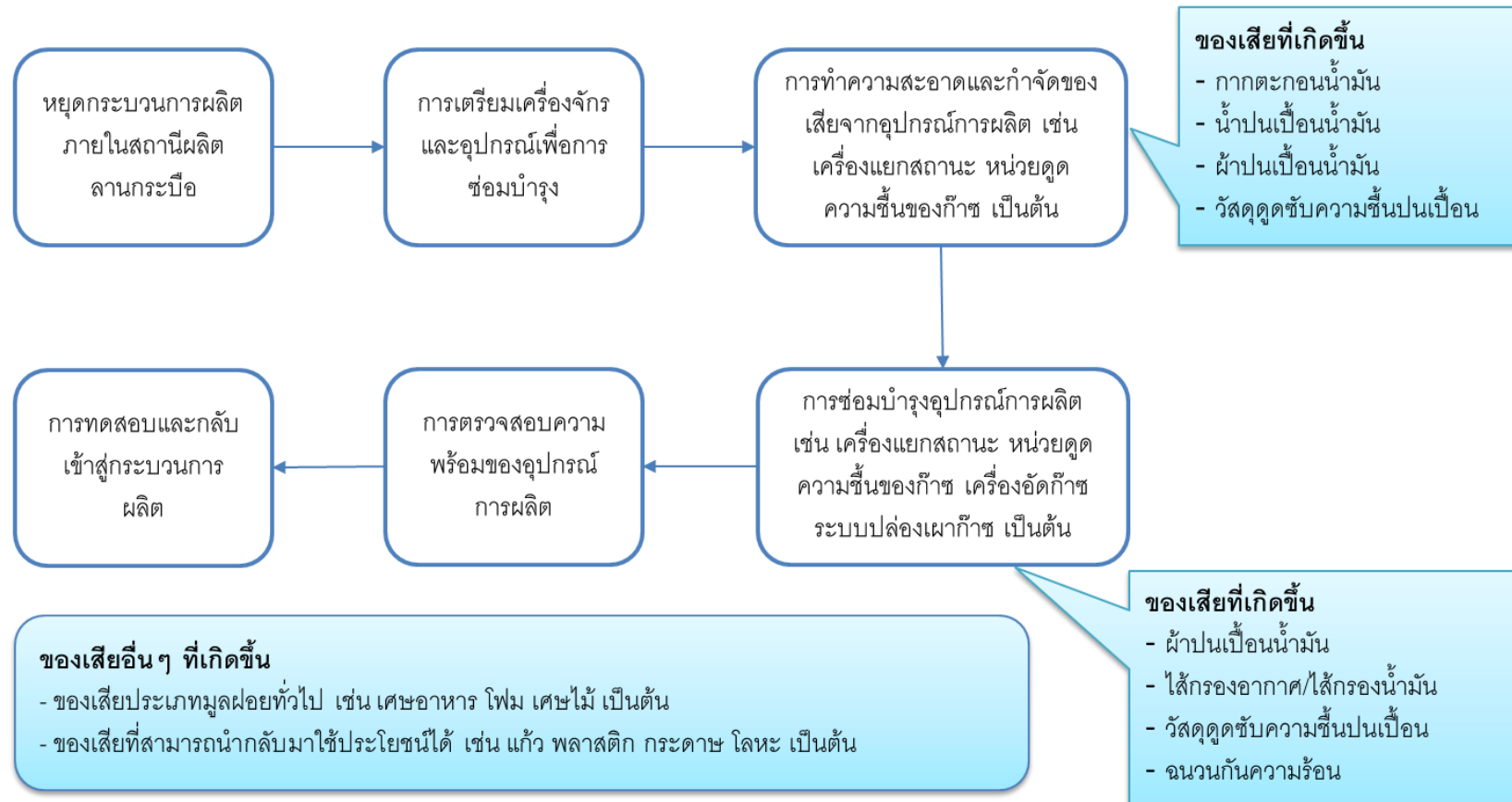
รูปที่ 2-19 แผนผังกระบวนการและแหล่งที่มาของของเสียระยะผลิตปิโตรเลียม (การหยุดผลิตปิโตรเลียมชั่วคราวเพื่อซ่อมบำรุง (Shutdown))
